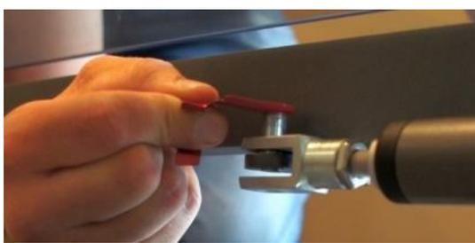
4. スプリングが抜けたらボルトを引き抜きます。
